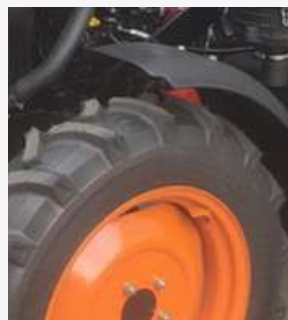
Крила з гнучкого пластику повністю закривають профіль колеса
