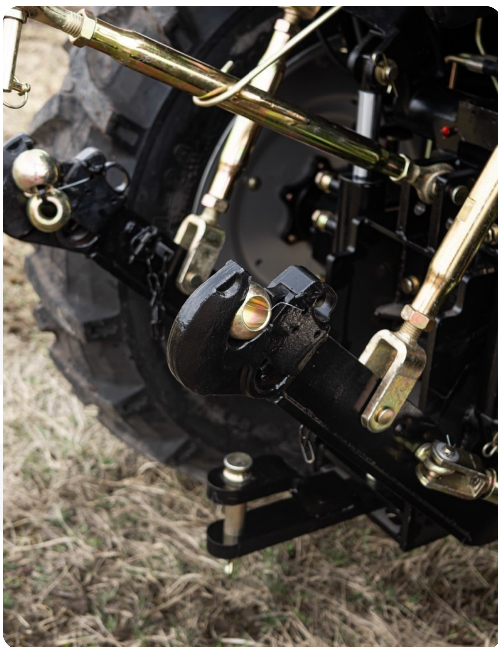
Навіска гачкама зі змінними яблуками розміром 24мм та 28 мм
