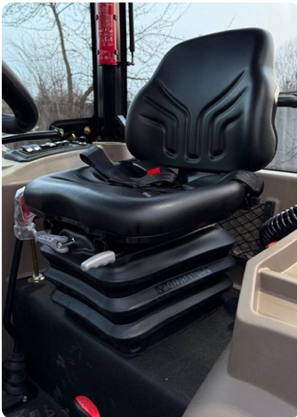
Преміальне ортопедичне сидіння фірми Grammer з регулюванням по вазі
