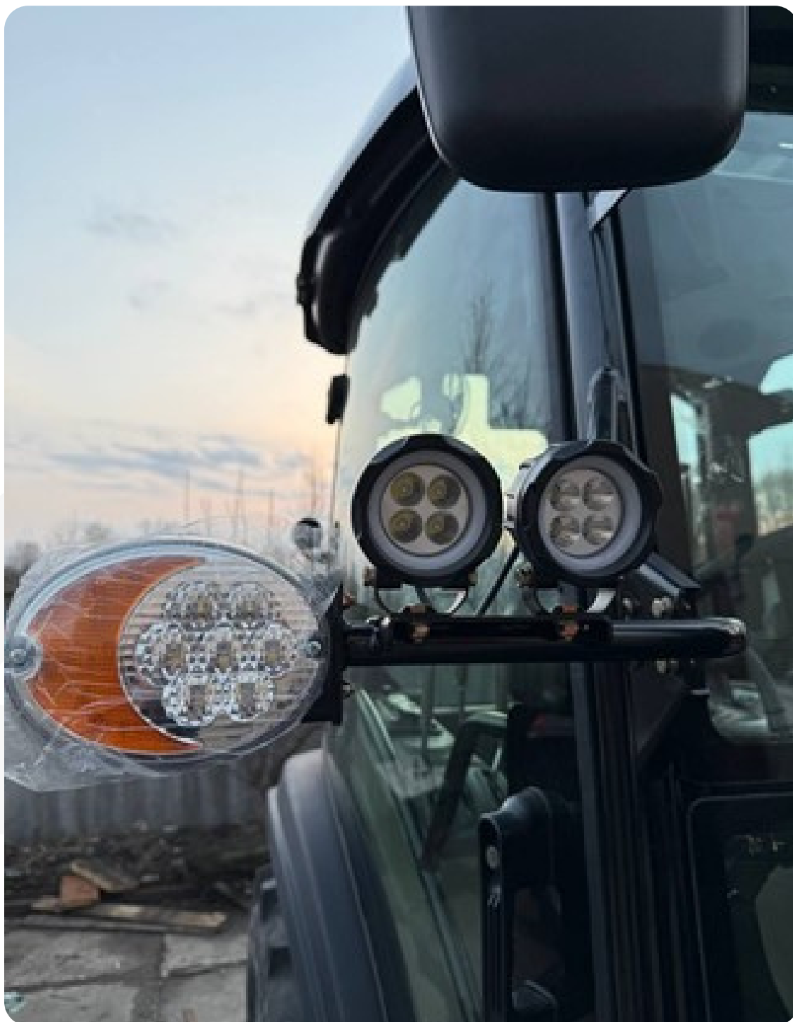
Зовнішнє освітлення навколо трактора 360°
