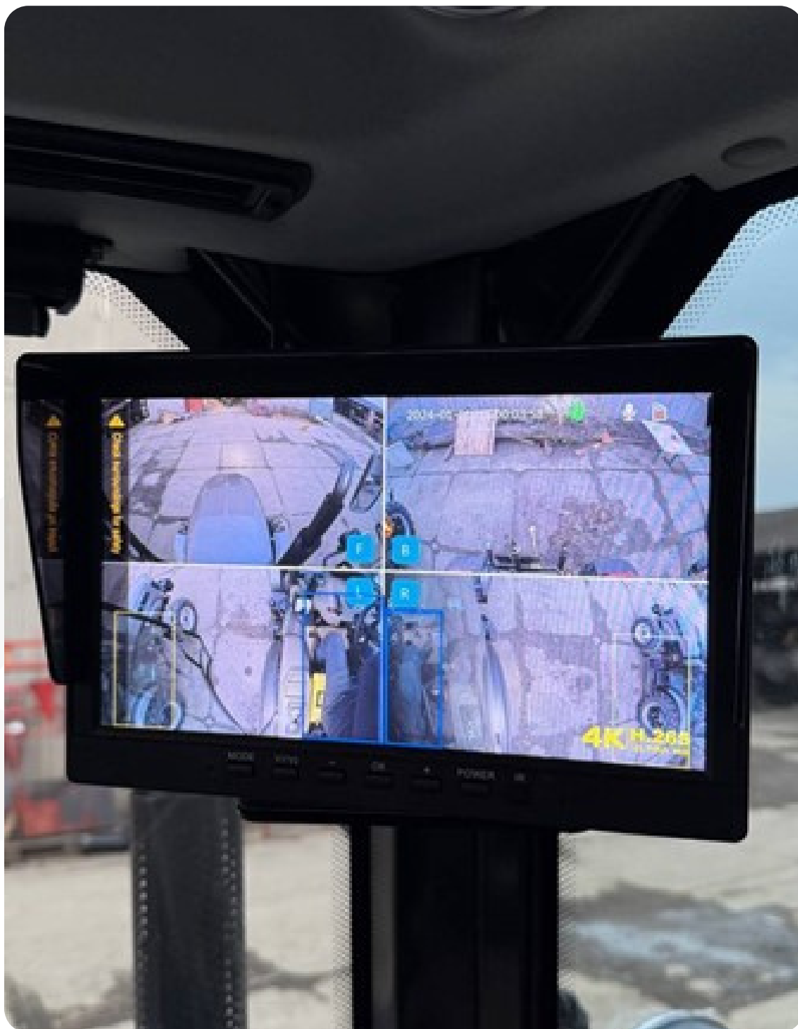
Встановлена камера з оглядом 360°, та екраном з розширенням 4к
